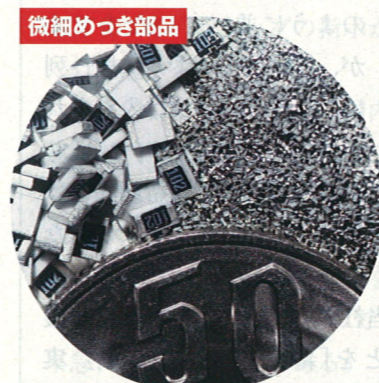
清川メッキ工業創業者の清川忠社長(写真右)は電子部品のめっきで世界屈指の技術力を持つ会社に育てた。砂粒のようなチップ(写真左)にもめっきできる
