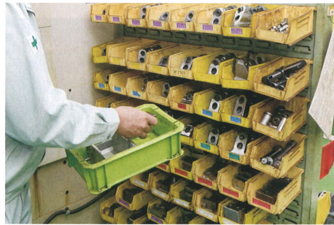
マシンにセットする治具を選び取る作業。この工程を外段取りに変更することを提案しました。
